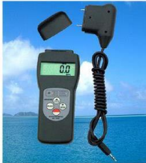
AHŞAP - TÜTÜN-PAMUK- KAĞIT - İNŞAAT-TOPRAK FİBER NEMİ ÖLÇEN CİHAZ
