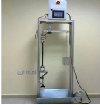
DAMLAMA BORULARINDA UZAMA TEST
